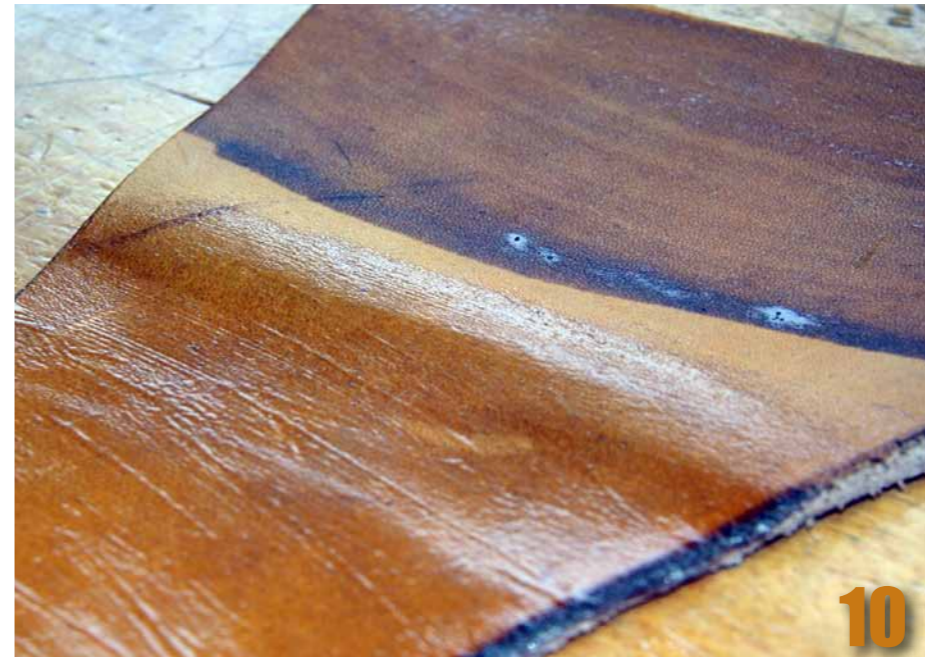
7 Zum Fetten der Leine wird ein Holz in den Schraubstock gespannt und ein dickes Stück Leder darübergerlegt, um die Leine zu schonen. 8 Für die Leinenpflege eignet sich am besten reines Bienenwachs. 9 Alle Leienteile werden sorgfältig eingerieben, sodass kein Wasser aufgenommen wird. 10 Öl färbt Naturleder mit unschönen schwarzen Schattierungen (oben im Bild), Lederfett bewahrt die natürliche Farbe.
