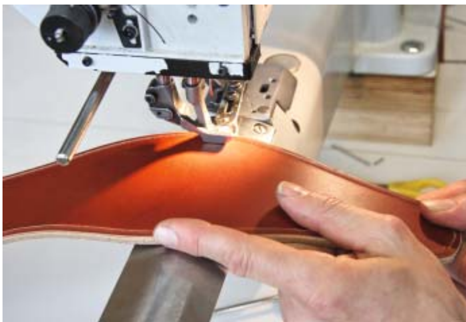
Bei einigen Geschirrtteilen werden die Nahtlöcher an der Maschine vorgestanz. Anschließend werden die Nähte mit der Hand vernäht und versenkt, um ein Aufscheuern zu verhindern.
