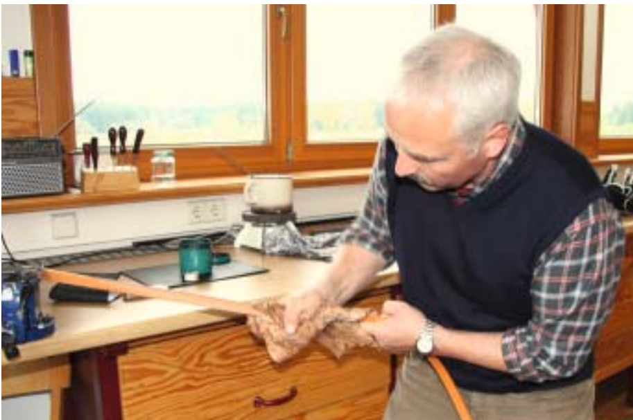
Andere handwerkliche Tätigkeiten erfordern Ausdauer, wie beispielsweise hier das Veredeln der Leinenkanten mit Knochenleim und das gleichzeitige Vorrecken der Leinen.
