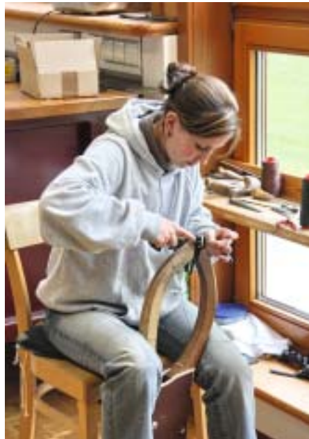
Das feine Sattlerhandwerk erfordert viel Sorgfalt und Konzentration, ob nun von Hand eine Schnalle vernäht wird oder die Einzelteile eines Kuntgeschirrs mit der Maschine.
