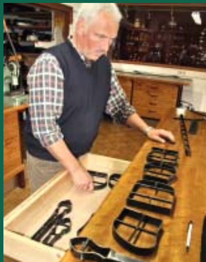
Blendklappen und Spieler werden mithilfe von Stanzformen zugeschnitten.
