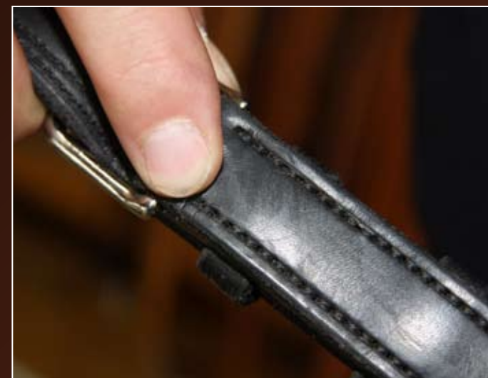
An Geschirrtteilen, die am Pferd oder anderen Geschirrtteilen aufliegen, sollen die Nähte versenkt sein, damit sie nicht aufscheuern.
