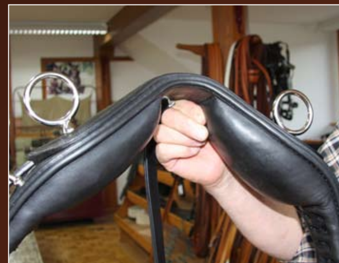
Die sorgfältige Ausformung mit Rosshaar verhindert, dass das Polster mit der Zeit zusammengedrückt wird und seine Federkraft verliert.
