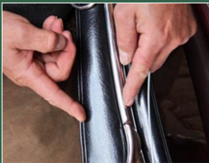
Die vier Finger breit Abstand entsprechen in etwa der Breite beziehungsweise der Auflagefläche des späteren Kumtleib.
