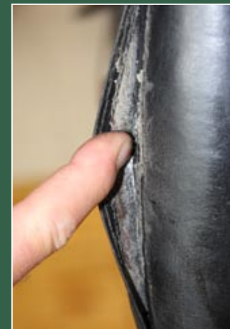
Billige Kumte werden am Hilfsrand geklebt und platzen dort später auf.
