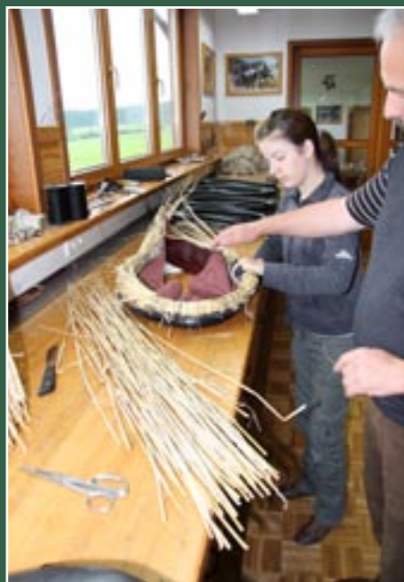
Das Stroh wird lagenweise zusammengenäht, um so die entsprechende Form zu erhalten.
