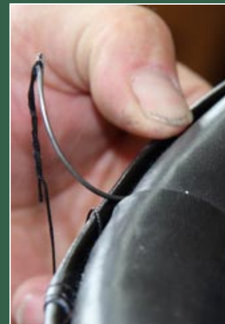
Der Kumthilfsrand wird bei Mönch verdeckt vernäht – Kleber ist Tabu.
